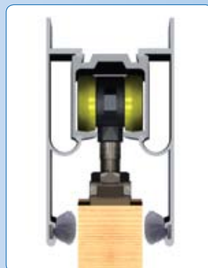
Przykład zastosowania wsuwanej szczotki przeciwkurzowej w systemie do drzwi przesuwnych HERKULES
